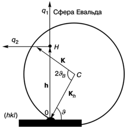
РИС. 2.3. Радіальний розподіл розсіяної інтенсивності вздовж вектора q , який отримується комбінацією поворотів аналізатора та зразка
