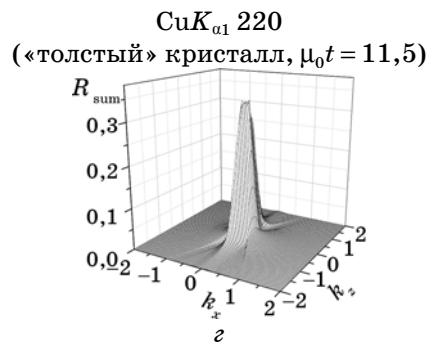
Рис. 9. Распределения полной картины динамического рассеяния в кристалле кремния толщины t = 320 мкм для рефлекса 220 в геометрии Брэгга для различных длин волн ( a и в — MoK α1 ; б и г — CuK α1 ) и разных типов дефектов: a и б — кластеры (см. подпись к рис. 3); в – г — дислокационные петли (см. подпись к рис. 7).
