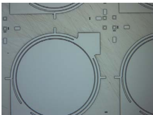
Рис. 10. Зовнішній вид кристала фотодіода після травлення мезаструктури.
